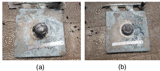
Gambar 15 Hasil permukaan luar benda cor ; (a) sampel sleeve mesh 40, (b) sampel sleeve mesh 60
